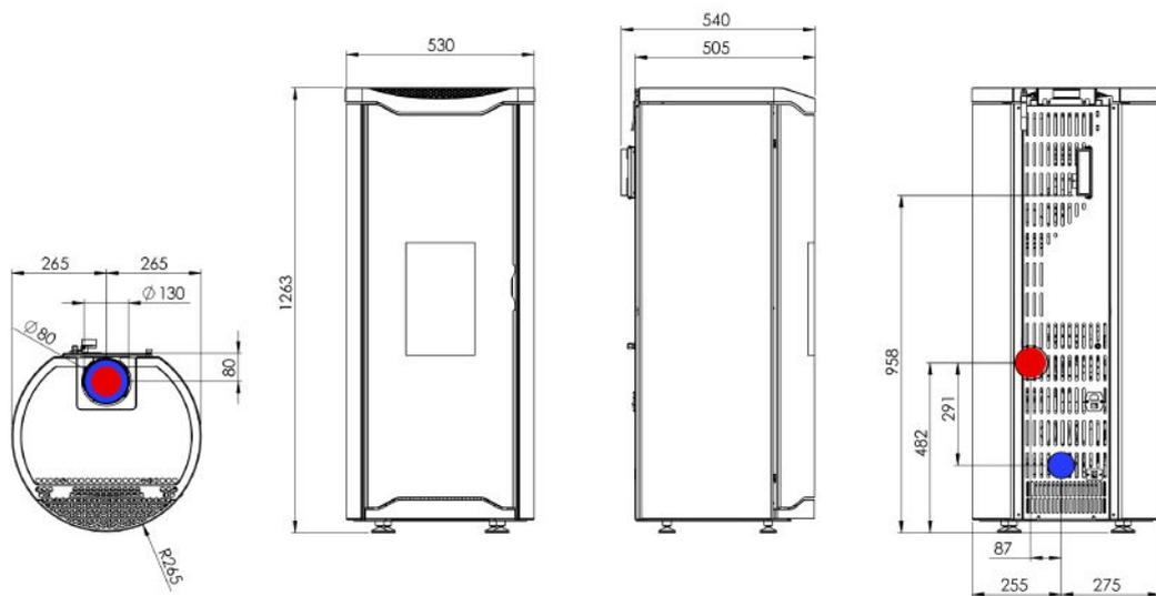
● Arrivée d'air ● Sortie des fumées
