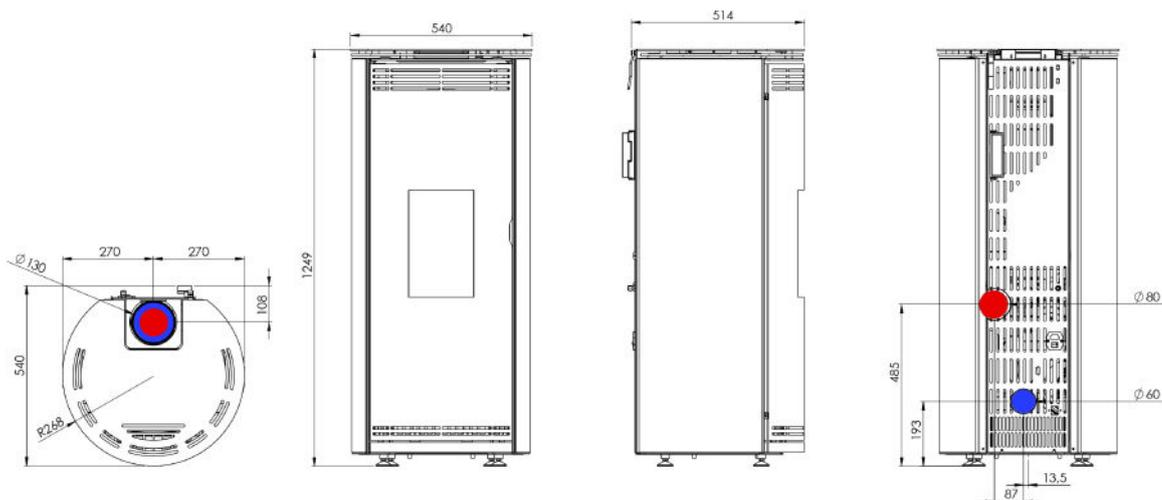
● Arrivée d'air ● Sortie des fumées
