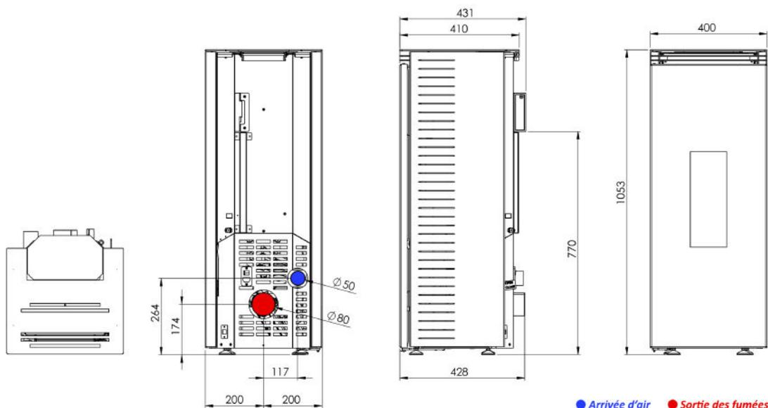
● Arrivée d'air ● Sortie des fumées
