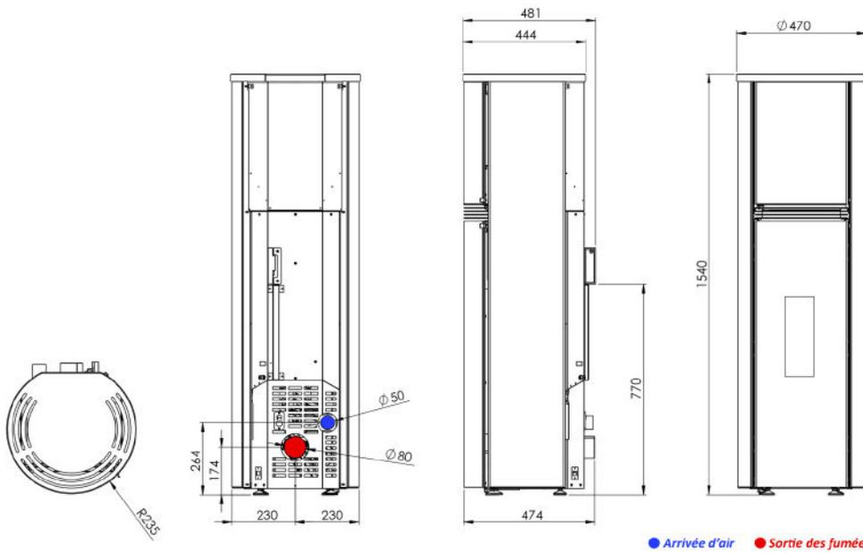
● Arrivée d'air ● Sortie des fumées
