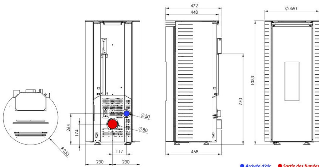
● Arrivée d'air ● Sortie des fumées
