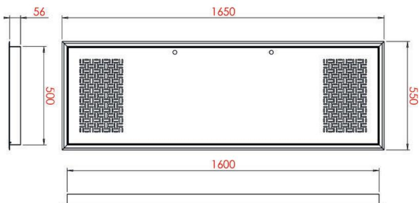
Afin d'accéder à la partie "Trémie" des appareils de la gamme VOLCAN, et pour effectuer le chargement en granulés de l'appareil, une porte de service optionnelle pourra être placée sur la partie latérale du coffre.
