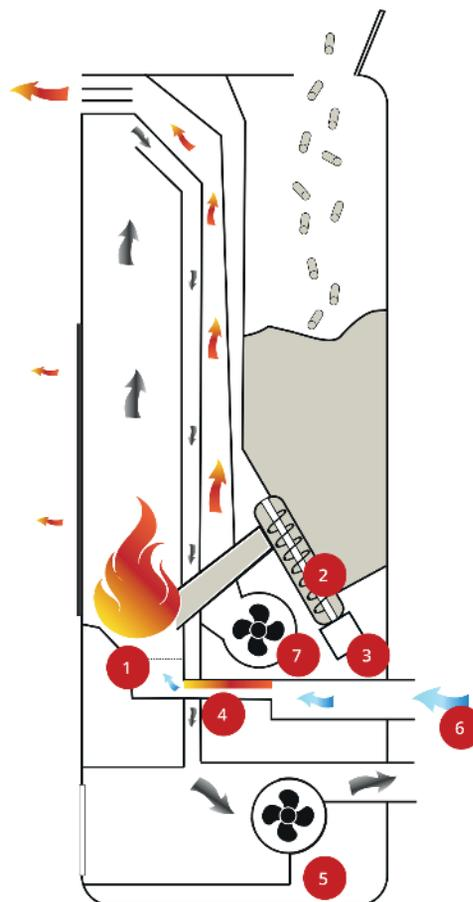
Le combustible entre dans le brûleur (1) grâce à une vis sans fin (2) actionnée par un moteur (3). Celle-ci le transporte depuis le réservoir jusqu'à l'intérieur du foyer.
