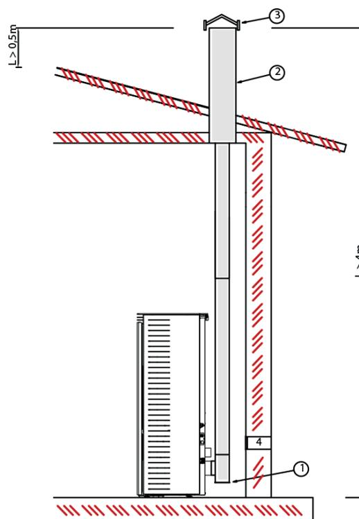
Nous préconisons un diamètre d'évacuation des fumées de 100mm jusqu'à une hauteur de 6m. Au delà, nous conseillons un diamètre de conduit de minimum 125mm. il est préférable de ne pas installer de poêle à granulés avec un conduit de fumées au dessus de 12m de hauteur.
