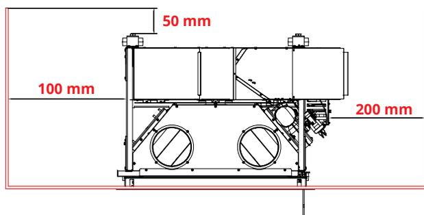
Un écart d'au moins 100 mm doit séparer le mur d'un des côtés, 200mm de la porte de chargement jusqu'au support carte mère et 50 mm de l'arrière du poêle. Respectez également une distance minimale de sécurité entre le tuyau de raccordement et le mur d'adossement conformément à la réglementation (NF DTU 24.1).
