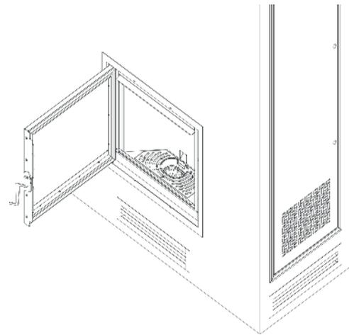
Afin d'assurer une bonne combustion, le poêle devra être nettoyé tous les jours à l'aide d'un aspirateur. La fréquence de nettoyage se fera en fonction de la qualité de granulé et de la durée d'utilisation.
