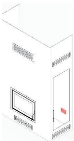
Pour assurer un bon débit, il est essentiel de mettre en place une entrée d'air d'une section libre de 50cm<sup>2</sup>, (soit environ 100cm<sup>2</sup> avec la grille métallique).
